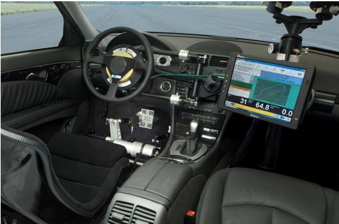
Abbildung 3.9: Fahr- und Bremsroboter von AB Dynamics. Sie sind speziell für die Wiederholbarkeit von genauen Parametervorgaben entwickelt worden [Dyn19a, Dyn19b]
