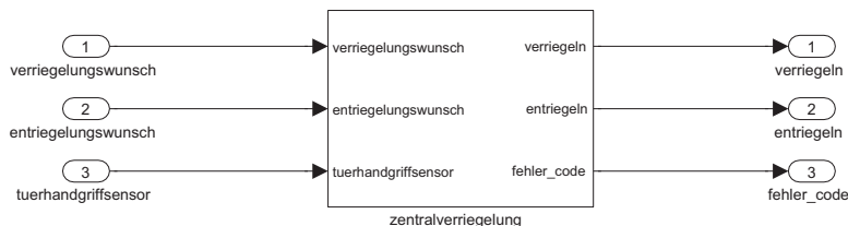
(a) Die Zentralverriegelung als separates Simulink-Modell
