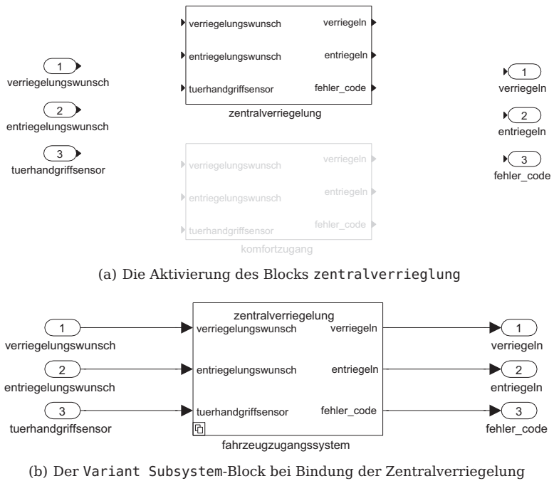
Abbildung 6.24.: Die Einbindung der Zentralverriegelung durch Aktivierung des Variant Objects
