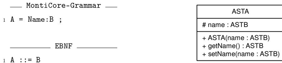
Abbildung 5.6.: Codegenerierung aus einer einfachen Produktion
